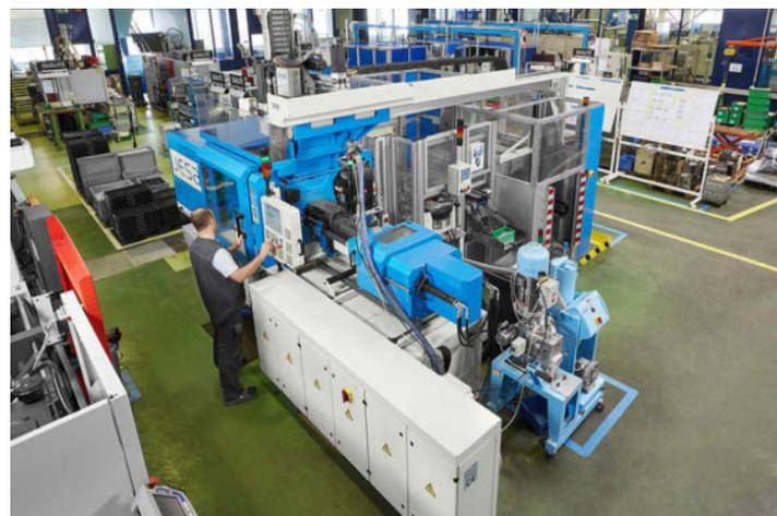
Sehr komplex und trotzdem kompakt ist die Turnkey-Anlage von Jesa aus der Schweiz (Bilder Mitte und oben rechts). Im komplexen Greifer befinden sich 16 Einlegeteile (Bild oben links), die in das 4-fach-Werkzeug eingelegt werden. Nur noch das Bestücken sowie die nachgeordnete Sichtkontrolle und Ablage erfolgen manuell (Bild oben Mitte).
