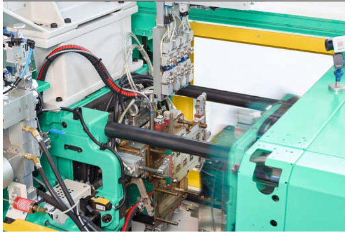
En la Fakuma se produjeron teclas de 0,09 gramos de peso a partir de dos componentes LSR (foto inferior) con un molde de 32+32 cavidades (foto superior dcha.). La producción era de casi 4000 piezas por hora (foto superior izda.).
