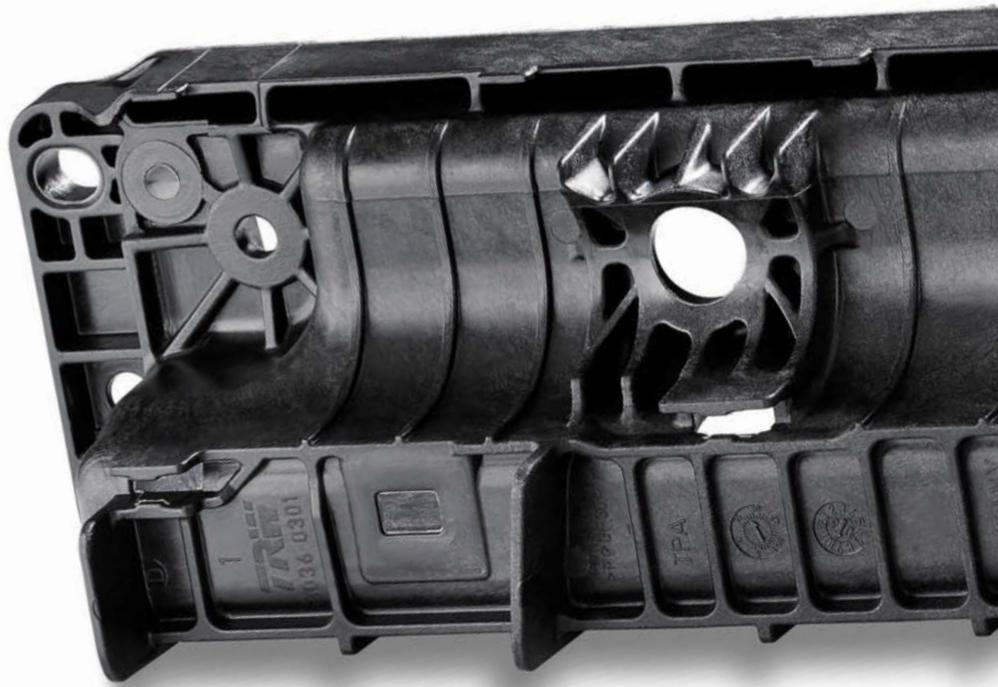
Während des Plastifizierungsvorgangs löst sich das Treibgas in der Schmelze und tritt erst mit dem Druckabbau beim Einspritzen in Form von mikrozellularen „Bläschen“ wieder aus. Ergebnis ist eine homogene Schaumstruktur. Bei den bislang untersuchten Materialien erfordert das Verfahren kein zusätzliches
