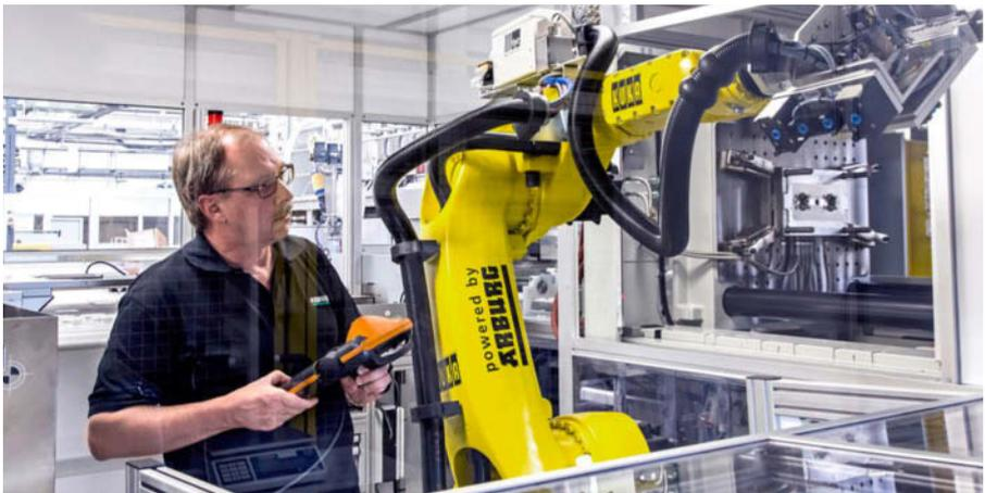
Die Zykluszeit 30 Millimeter dicker Linsen (großes Bild) beträgt bis zu 18 Minuten. In dieser Zeit führt der Sechs-Achs-Roboter weitere Produkte einer Laserbearbeitung zu (Bilder oben rechts und Mitte). Der Roboter kann komfortabel programmiert und auf andere Produktvarianten umgerüstet werden (Bild unten rechts).
