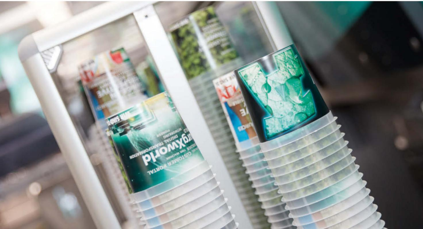
Ahorro de recursos y energía: vasos IML de paredes delgadas producidos mediante inyección por compresión (foto grande).
