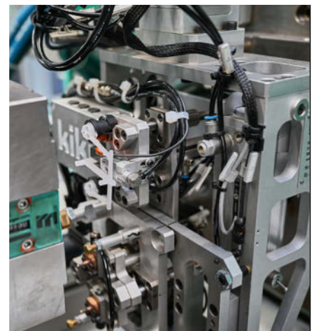
En la instalación "llave en mano" (foto a la izquierda), la garra introduce primero los imanes en el molde y retira luego las piezas moldeadas y la colada (foto arriba).
