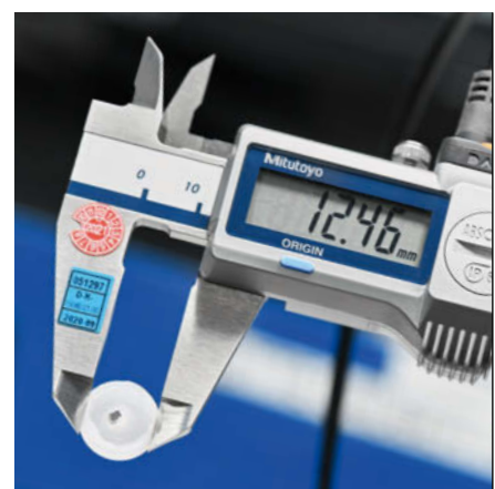
El pulsador de filigrana con imán en el centro tiene un diámetro de unos 12,5 mm (fotos arriba) y se fabrica en una instalación "llave en mano" alimentada manualmente con cargadores de imanes (foto a la izquierda).
