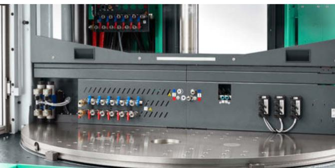
Le concept de plateau tournant sans colonne facilite l'accès aux raccords d'alimentation.
