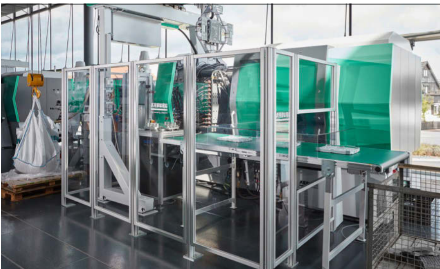
从杯子变成再生料，再制作成折叠盒（上图）——这是 ARBURG（阿博格）在劳斯博格的客户中心用一台 ALLROUNDER 920 H 生产的产品（左图）。
