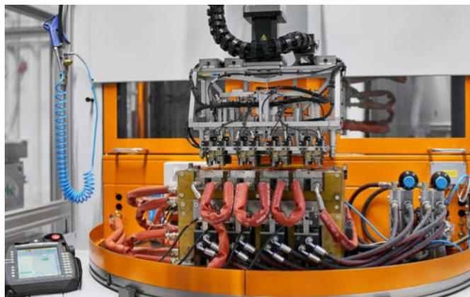
Un robot à six axes (photo en haut à gauche) alimente les pièces injectées dans le contrôle par caméra (partie arrière) et dans le triage, puis dépose les pièces bonnes (partie avant). Avant le surmoulage, le poste de chauffage amène les paquets rotor à la température du moule (photo en haut à droite). Le MULTILIFT V les y prélève et les insère du côté éjecteur du moule, puis il prélève les pièces finies (photo à gauche).
