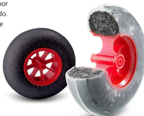
La rueda para aviones de aerodelismo demuestra el potencial del proceso PCIM. Durante la inyección de la llanta se crea una firme unión con el neumático de espuma (izquierda). En el paso siguiente se sobreinyecta el neumático con un componente TPE (derecha).
