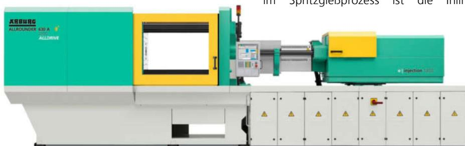
Zu den Innovationen der Fakuma gehören z. B. der neue elektrische ALLROUNDER 630 A (links) und mittels Partikelschaum-Verbundspritzgießen (PVSG) produzierte Räder für Modellflugzeuge (oben).
