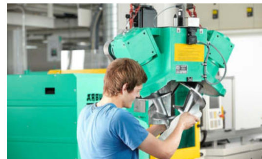
Da sich die beiden Schnecken (oben) einfach und schnell reinigen lassen (Mitte), reduzieren sich die Stillstandzeiten deutlich.
