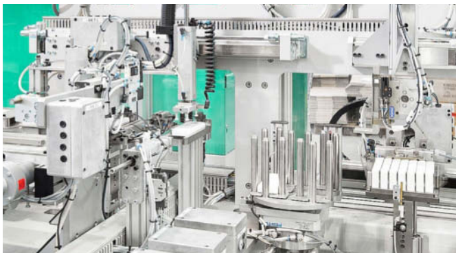
Das lineare Robot-System fügt Behälter und Deckel und leitet sie zum Stapeln an eine Übergabeeinheit weiter.
