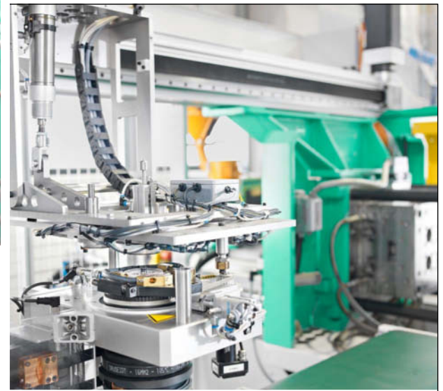
Der 4-fach-Greifer (links) fährt zur Übergabestation (rechts), wo die vier Greiferkerne einzeln mit Schlauchabschnitten bestückt werden.
