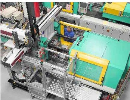
ces montées sur un convoyeur refroidi, afin de les refroidir avant le conditionnement final. Le « eDART System » de RJG sert à la surveillance de la qualité du produit dans cette cellule de fabrication. En
