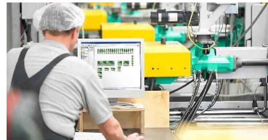
nau, environ 2 500 tonnes de plastique sont transformées pour la fabrication de 300 millions de pièces. Les spécialités fabriquées ici sont les couvercles à joint pour la fermeture étanche des bocaux, fabriqués intégralement à base de deux composants.
