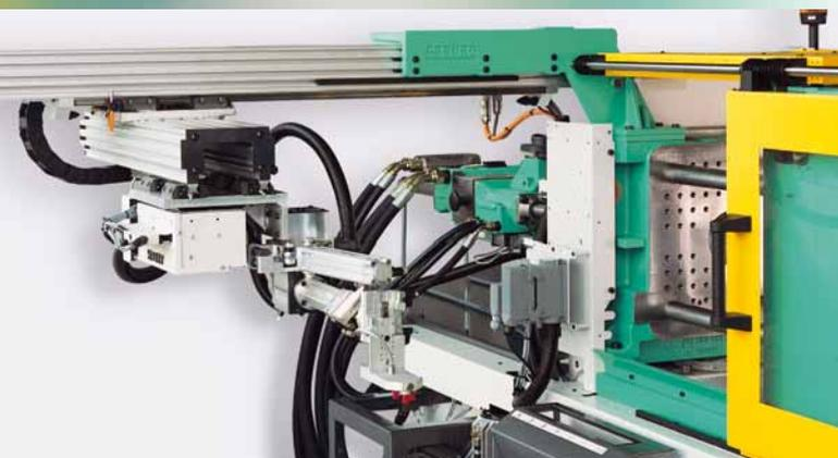
*MULTILIFT H sans capots de protection – la première étape d'un système de manipulateur modulaire.*
