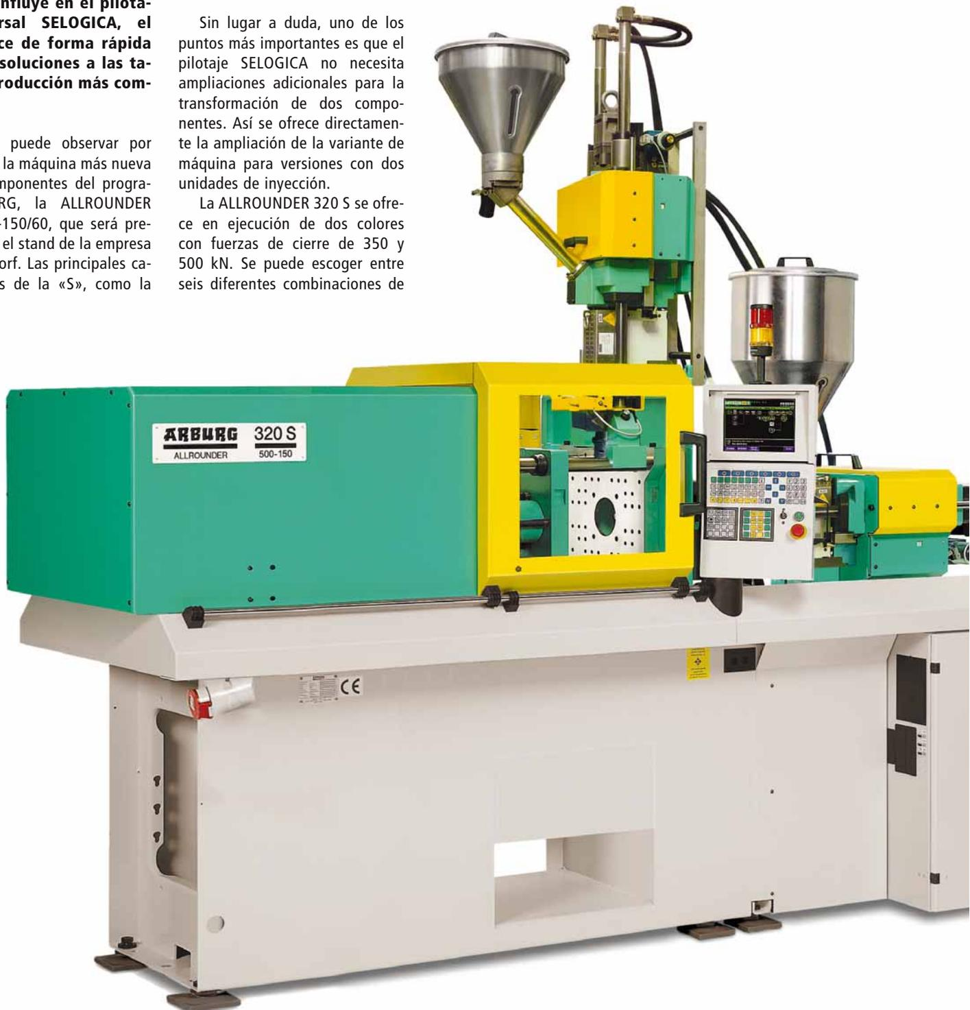
dispositivo de la unión del molde para soportar la unidad de inyección vertical, se soporta en las dos columnas superiores de la unidad de cierre y, por tanto, mediante desplazamiento horizontal puede ajustarse a cualquier configuración de molde. El alargamiento de las columnas en 100 mm, hace posible la utilización sin problemas de un molde de dos colores con periféricos más voluminosos.
