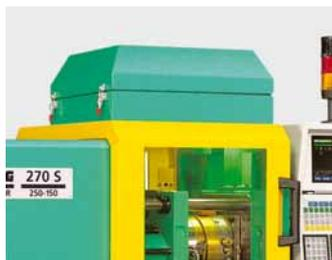
gera sobrepresión, lo cual impide de forma eficaz la penetración de partículas de polvo en la zona de cierre de la máquina.
