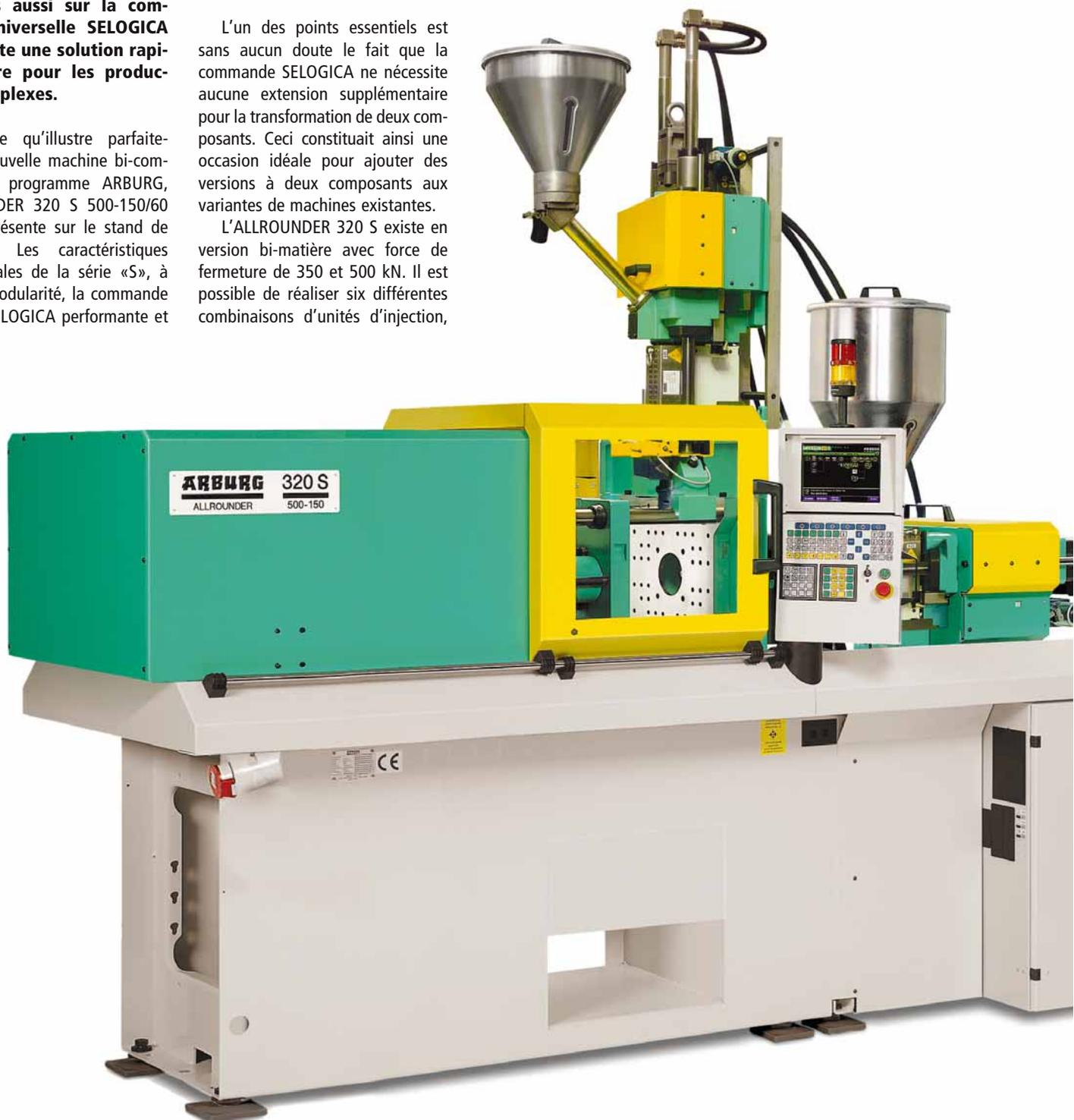
tion verticale se positionne sur les colonnes supérieures de l'unité de fermeture, ce qui permet de l'adapter à chaque configuration de moule par simple déplacement horizontal. Les colonnes rallongées de 100 mm permettent également de monter sans problèmes des moules bi-matière complexes avec d'importants équipements périphériques.
