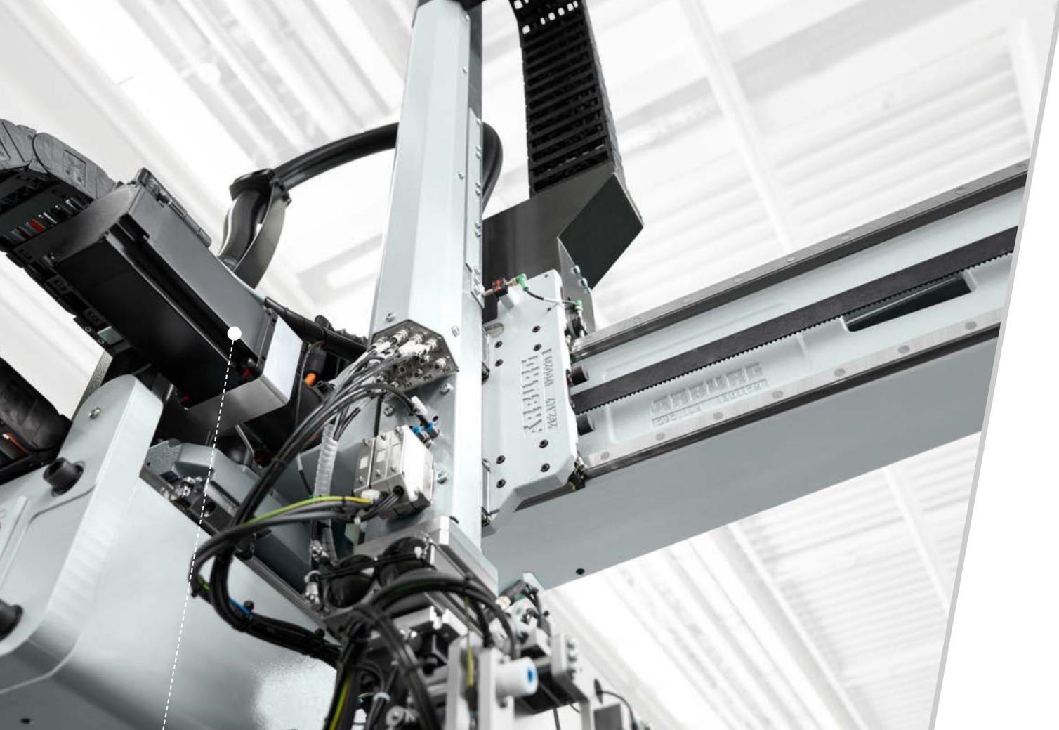
Tecnologia de acionamento de alta qualidade: movimentos simultâneos, rápidos e precisos por meio de servomotores e reguladores separados.
