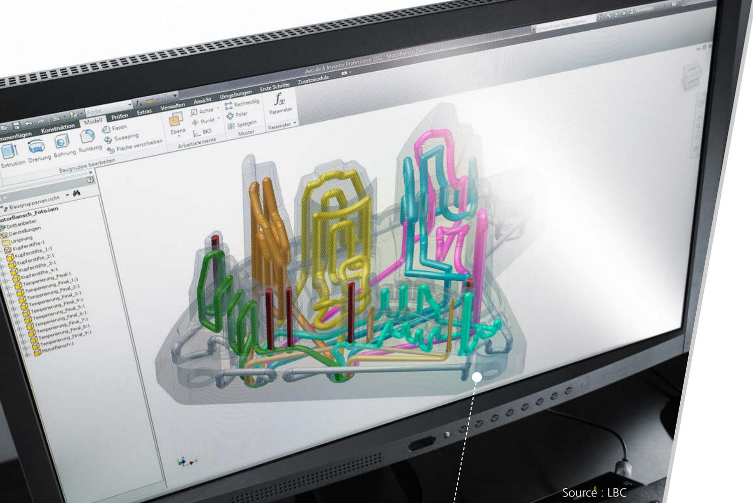
La régulation de la température à proximité des contours diminue le temps de cycle et assure une grande capacité de régulation des processus.
