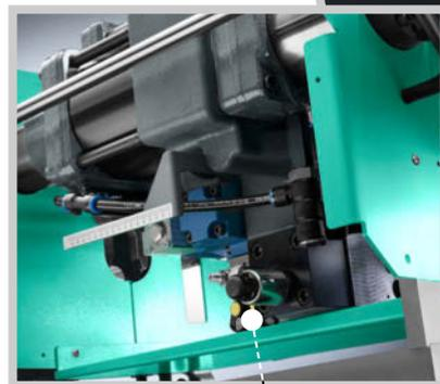
Precisão: injeção reproduzível por válvulas próximas ao acionamento.
