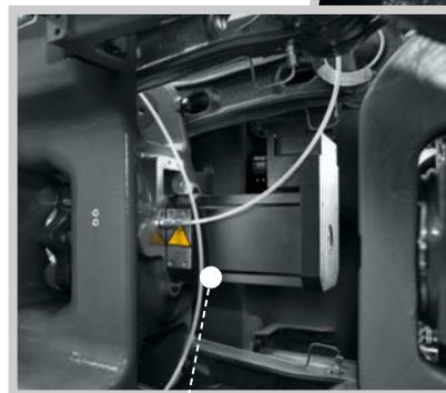
Éjecteur servoélectrique (option) : chute très précise des pièces injectées qui réduit encore le temps de cycle.
